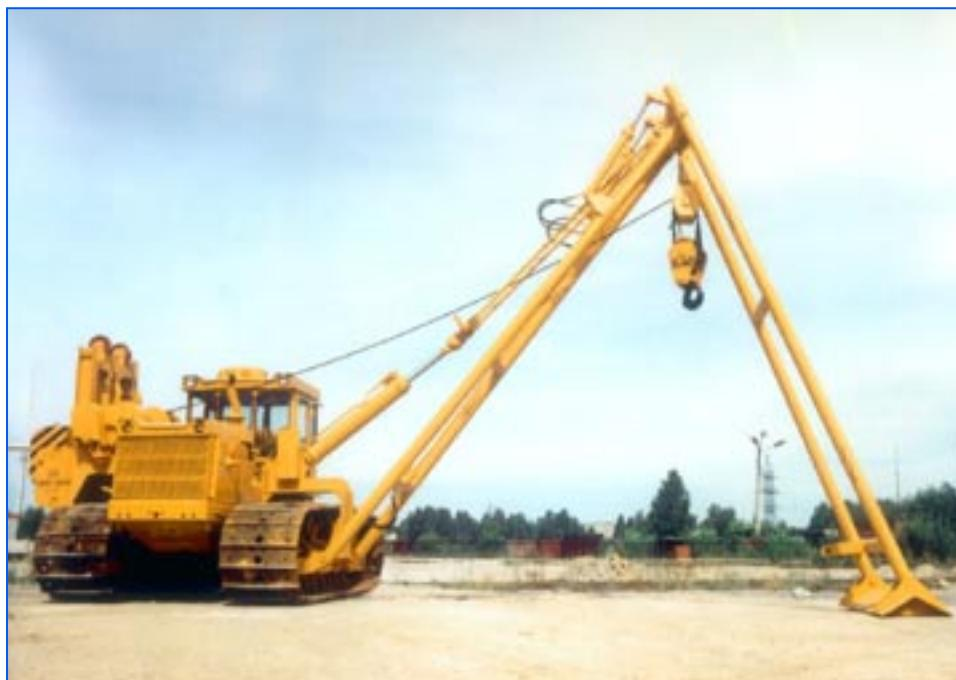
Предназначен для выполнения грузоподъемных операций по перемещению грузов, укладывания трубопроводов в траншее и на эстакаде, на грунтах с пониженной несущей способностью.
